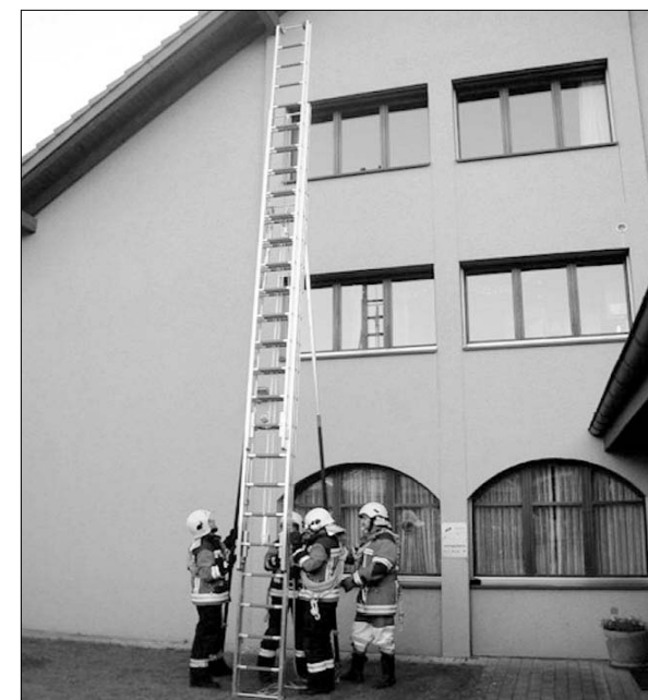
3-teilige Schiebeleiter mit einer maximalen Höhe von 14m.
