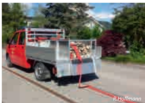
Neues Fahrzeug mit Schlauchkassette auf Alubrücke.
