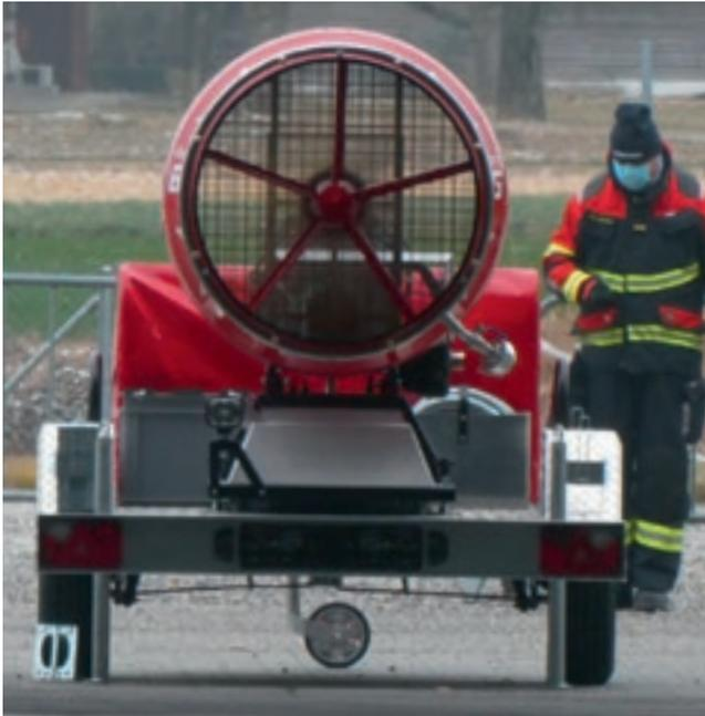
Mit dem mobilen Grossventilator können die Rauchgase und auch die Hitze in Gebäuden reduziert werden.
