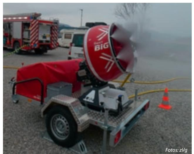
Ein sehr wichtiges Element ist der Wasservernebler, er ermöglicht die Kühlung eines Objektes mit wenig Wasser.
