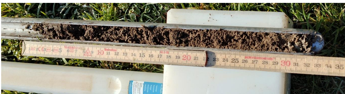
Abb. 7 Die Bohrung zeigt unterhalb von 30 cm Sand und Kies
