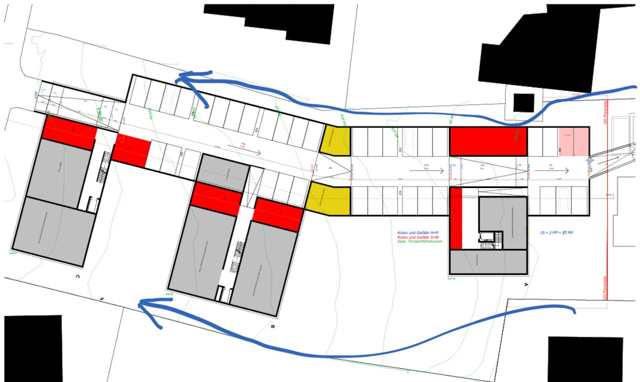
Abbildung 4: Umgebungsgestaltung des Bauvorhabens mit Baufelder A, B und C. grün hinterlegt: Terrainkoten vor Umsetzung des Bauvorhabens. Blaue Pfeile: bestehende Abflusskorridore, die erhalten bleiben müssen.
