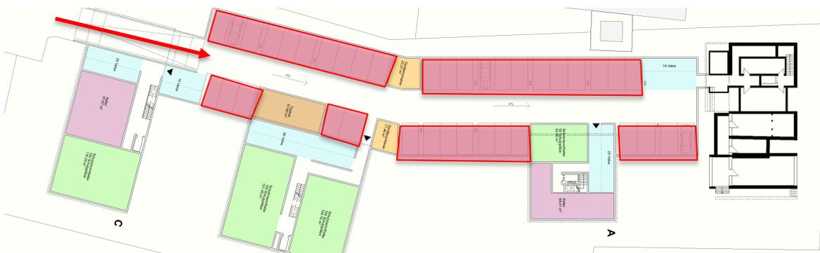
Abb. 15 Situationsplan der Einstellhalle mit Zufahrt ab Lochweg (roter Pfeil), den Autoabstellplätzen (rot eingefärbt) und den Veloabstellplätzen (blau eingefärbt).
